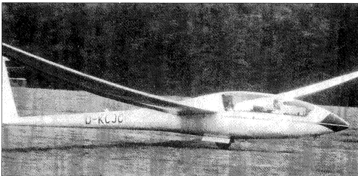
Det bestilte Super-svævefly en NIMBUS 3 DT med "hjemhentningsmotor" Spændvidde 24.60 m og et glidetotal på 57.
